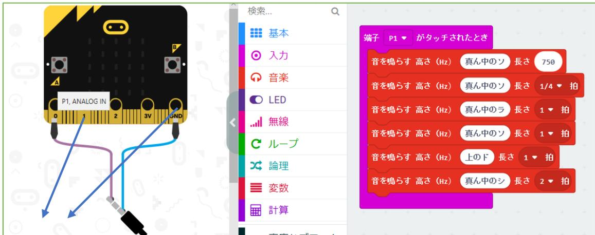
P1端子とGND端子の間に電流が流れると動作
