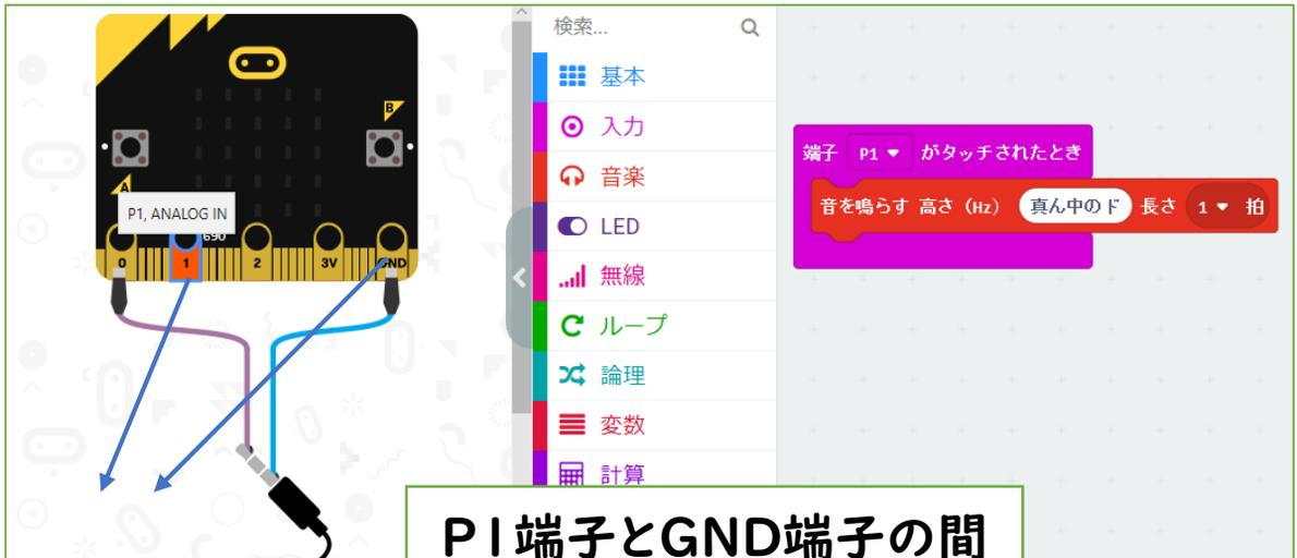
P1端子とGND端子の間に電流が流れると動作
